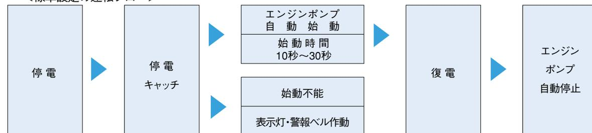
●自動始動盤に標準設定の回路で、水位に関係なく停電で自動始動し、復電で自動停止します。
