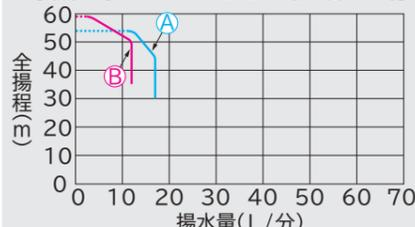
**A** 吸上高さ30m、運転圧力:「標準」(OFF圧力240kPa)
