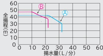
**A** 吸上高さ18m、運転圧力:「標準」(OFF圧力240kPa)
