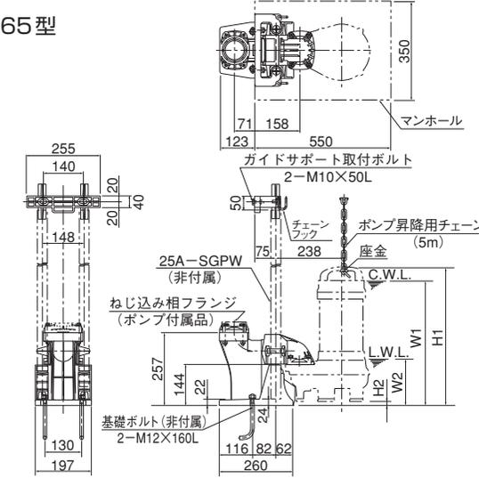
※ガイドフック取付ボルトは水中ポンプ付属品を使用します。
