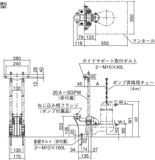
※ガイドフック取付ボルトは水中ポンプ付属品を使用します。
