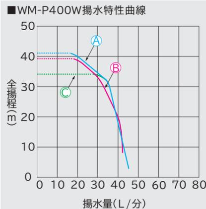
●A 吸上高さ3m、運転圧力:「高」(OFF圧力380kPa)
