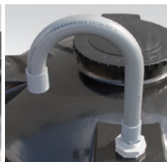
U型アミ付 虫などがタンク内に侵入するのを防ぎます。 65A以上はエルボ型
