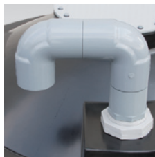
エルボ型 サイズ65A以上の エア抜きに使用
