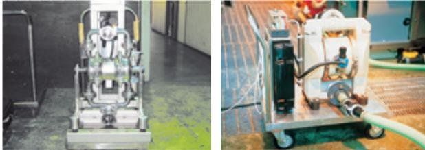
複数ラインでの使い回しやテスト運転、持ち運びに便利な台車タイプ。さらに、ご希望の補器を全てセットしたユニットタイプもご用意しています。
