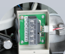
信号出力端子台 (ポンプ背面に設置) 写真はカバーを外した状態です。
